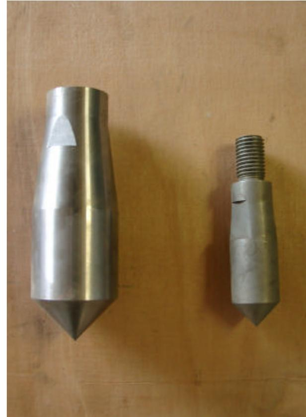
Ansicht der Rammsondenspitzen nach DIN 4094 für die schwere Rammsonde DPH (links) und die leichte Rammsonde DPL-5 (rechts)
