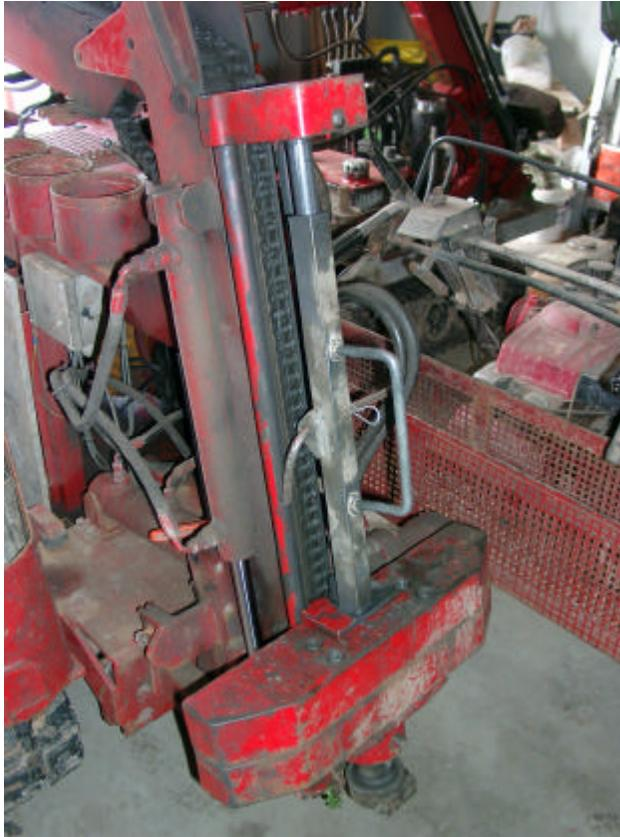
Ansicht des 50kg-Fallgewichtes der schweren Rammsonde DPH mit einer Fallhöhe von 50 cm.
